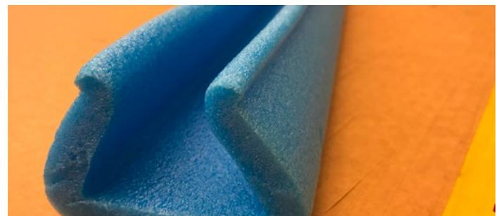
**Kanten- und Eckenschutz:** Schutz für Kanten und Ecken bieten diese U-Profile aus hochwertigem Polyethylen (PE-LD), die es in verschiedenen Breiten und Längen gibt. Mit einem einfachen Cutter kann das Material perfekt auf jede gewünschte Länge zugeschnitten werden und schützt dann vor Stössen, Schlägen und Kratzern. Zudem sind die Schaum-Profile widerstandsfähig gegenüber Feuchtigkeit und grossen Temperaturunterschieden. Die Profile sind recycelbar und lassen sich mehrfach verwenden.
