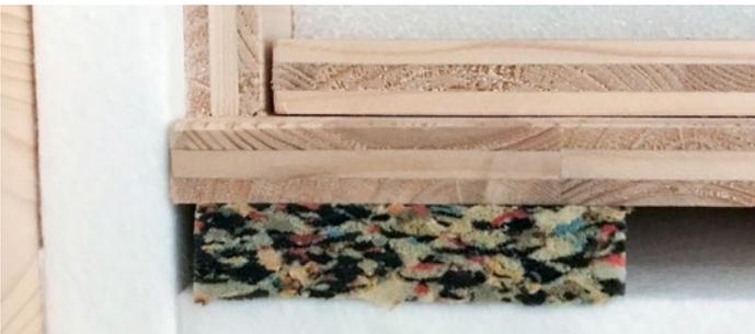
**Kunststoffe zur Vibrations- und Schockdämpfung und zur Isolierung:** Die optimale Verpackung eines Kunstwerks basiert auf der Einschätzung von dessen Fragilität und den möglichen Einwirkungen und Belastungen, welchen das Werk während eines Transportes ausgesetzt werden könnte – Temperaturunterschiede, Stösse und Stürze oder andere kurz- oder auch längerfristige Einwirkungen wie Vibrationen während eines Landtransports, z.B. im Auto, Camion oder LKW.
