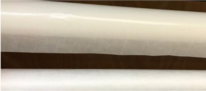
**Halbschlauchfolie/Schlauchfolie (PE-LD):** Diese transparente Folie für die äussere Verpackung wird aus Polyethylen (PE) mit geringer Dichte (Low Density LD) hergestellt und weist daher eine hohe Dehnfähigkeit und Widerstandskraft gegen Risse auf. Sie ist wasserabweisend, sehr stabil gegenüber Chemikalien und physiologisch unbedenklich. Zudem ist die Folie antistatisch und uv-stabilisiert, d.h. lichtecht.
